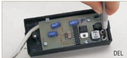
Stlačte tlačidlo DEL a držte ho stlačené po celú dobu mazania. Začiatok mazania je signalizovaný **krátkym prerušovaným pípaním**. Ukončenie mazania je signalizované **jedným dlhým pípnutím**. Uvoľnite tlačidlo DEL. Všetky identifikátory boli vymazané. Ak priložíte identifikátor do čítacieho poľa, budete počuť jedno krátke pípnutie, relé sa nezopne.
