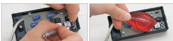
Pre nastavenie MASTER kľúča stlačte tlačidlo PRG, keď budete počuť **rýchlo prerušovaný tón** uvoľnite tlačidlo PRG a stlačte tlačidlo DEL. Hneď ako sa ozve **prerušovaný tón - pípanie** tlačidlo DEL uvoľnite a počas trvania prerušovaného tónu priložte do čítacieho poľa OPJ RAK BES SLIM identifikátor, ktorý chcete používať ako MASTER.
